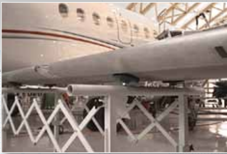
Stützteller mit Schaumauflage für sicheren Transport oder Bearbeitung
