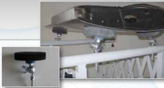
Stützteller mit Schaumstoffauflage für variable Höhen- und Neigungseinstellungen
