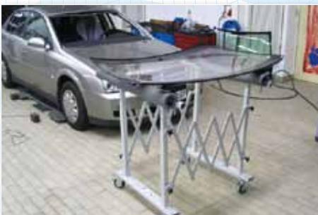
Arbeitsbock mit Schaumauflage und Stütztellern zum Beispiel für Teilemontage, Glasmontage, Lackierarbeiten u.s.w.
